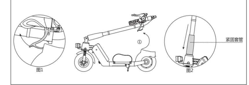
1. 放下撑脚，把Z5平放在地面，用手握住挂钩（见图1），使挂钩从挂钩卡口处脱离（见①箭头所示），将车头推至垂直，紧固套管自动下滑，使圆管固定（见图2）。
