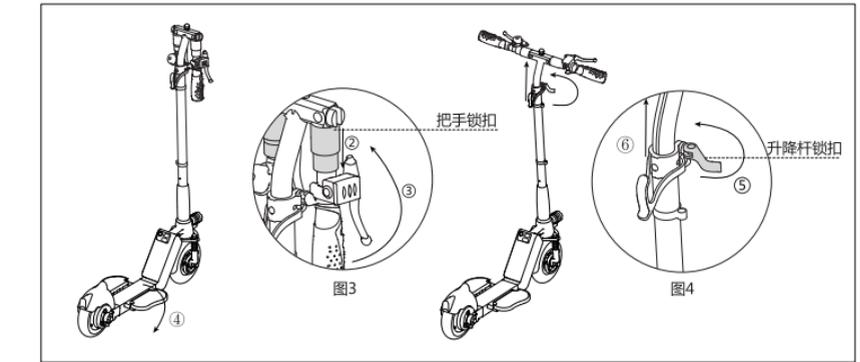
2. 摆正车头后，将两边把手上的把手锁扣下拉（见图3-②箭头），并将两个把手展开（见图3-③箭头所示），然后释放把手锁扣，将把手固定，之后放下脚踏板（见④箭头）。
