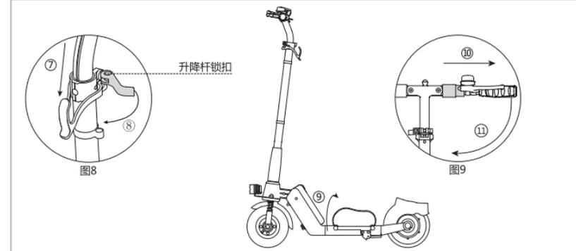
① 打开升降杆锁扣,降下车头(见图8-⑦箭头所示),闭合升降锁扣(见图8-⑧箭头所示),收起脚踏板(见图⑨箭头所示),轻拉把手锁扣(见图9-⑩箭头所示),同时将把手向下折(见图9-⑪所示),释放把手锁扣,将把手折叠。
