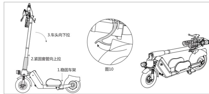
② 稳固车架,将紧固套管向上拉,车头向下拉,当挂钩到达挂钩卡口处时,向下握住挂钩,将挂钩扣在挂钩卡口处(见图10),完成折叠。
